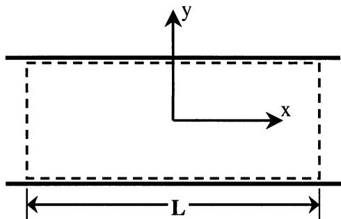
Finn de kraftene som virker på fluiden inne i kontrollvolumet, både i  $x$ -retning og i  $y$ -retning. Finn kraftene som virker fra fluidet inne i dette kontrollvolumet på beltene.
