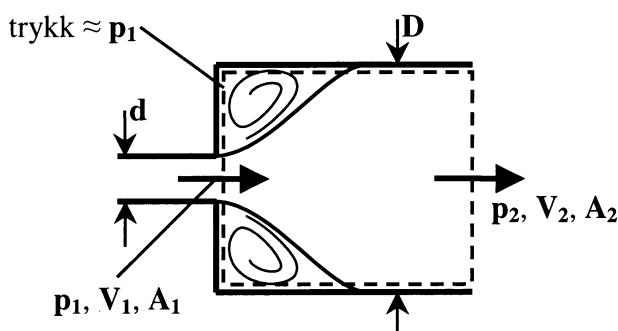
Et rør med diameter  $d$  utvider seg brått til et rør med diameter  $D > d$ . I røret strømmer et inkompressibelt fluid med tetthet  $\rho$  stasjonært og turbulent mot høyre som vist i figuren. Det dannes en såkalt separasjons-sone karakterisert ved hvirvler med lav hastighet og lav friksjon, og strømningen vil gradvis utvikle seg nedstrøms til den dekker hele rørtverrsnittet  $A_2$ .
